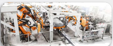
自動車のボディ処理、溶接
