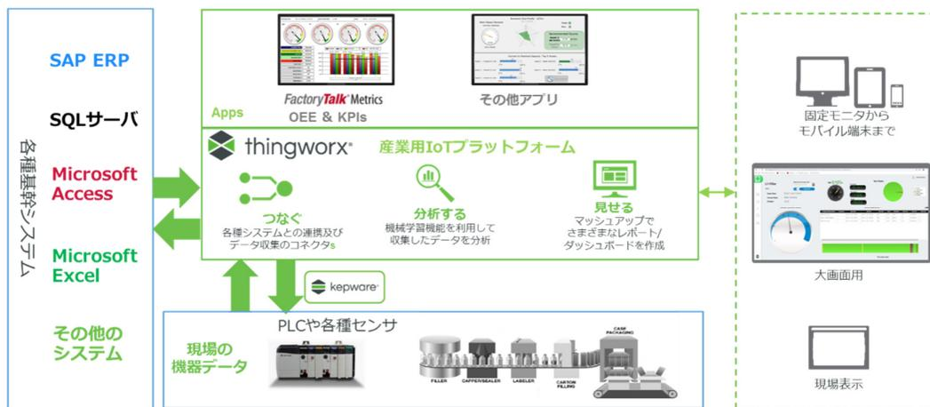
こうした作業を実現する為に、ロックウェル・オートメーションがご紹介するシステム構成は上図のようになります。現場のデータをデータゲートウェイ経由で吸い上げ、IoT プラットフォームに格納します。このプラットフォームは様々な外部システムと容易に連携が可能のため、ERP システムと連動させてオーダー番号と現場のワークの流れを紐付けさせることもできます。そして、OEEの自動計算を実行するアプリケーションソフトウェアをこのプラットフォーム上で走らせ、OEEを算出します。このアプリ上でも OEE 関連のデータ表示およびある程度のドリルダウンは可能ですが、見やすくダッシュボードで見せたいということであれば、IoT プラットフォームのダッシュボード作成機能でお好みのダッシュボードを任意に作成することが可能です。こうすることで、見せたい人の階層に合わせて複数の画面を用意できます。
